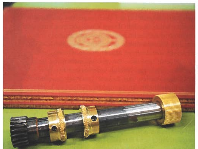
Werkzeug zur Verzierung der Innen- und Stehkanten von Buchdecken.
